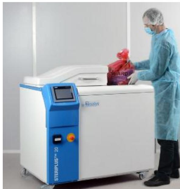
avec un broyeur intégré, qui réalise un broyage préalable des déchets et un cycle d'autoclavage à la vapeur à 135°C.
