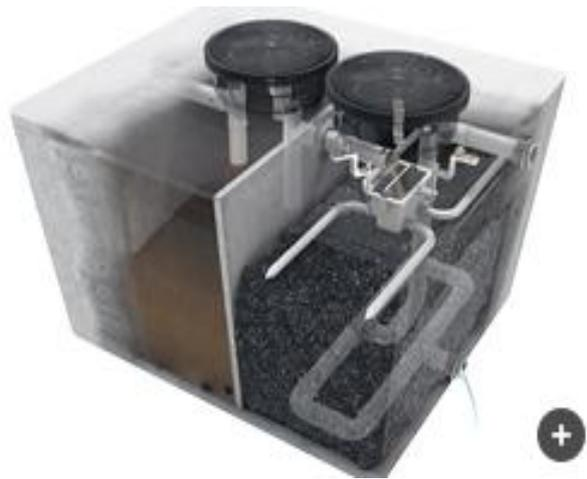
Le filtre compact X-Perco® fonctionne grâce au principe de percolation, un procédé simple et économique qui s'effectue gravitairement en deux phases : la décantation primaire et la filtration à travers un média filtrant.
