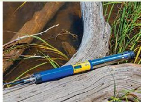
Personnalisable, AquaTROLL 600 s'adapte aux besoins d'analyse des paramètres physico-chimiques : température, conductivité, pH/ORP, oxygène dissous (optique), turbidité, nitrate, chlorure, ammonium, ammoniac, niveau d'eau (capteur de pression absolue ou relative).
