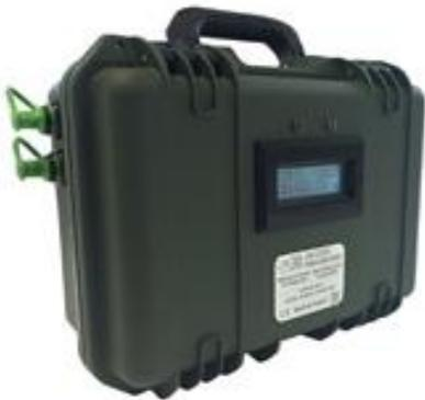
La grande fiabilité de l'AM 3000 constitue une caractéristique et un atout majeur de l'appareil : le débitmètre massique dont est dotée la pompe compense en température et en pression, ce qui permet un débit de prélèvement régulé tout au long des opérations de mesure.
