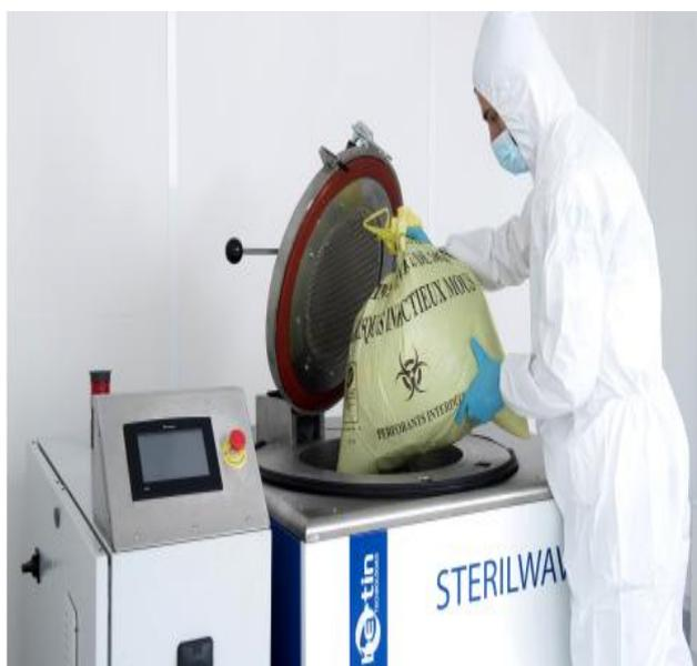
En seulement 30 minutes, les déchets d'activité de soins à risques infectieux (DASRI) sont convertis en déchets compacts, secs et inertes, avec une réduction de poids de 25% et une réduction de volume de 80%. L'inactivation microbienne étant supérieure à  $8\log_{10}^*$  (conformément aux normes internationales les plus exigeantes), les déchets peuvent alors être assimilés aux déchets ménagers et intégrés dans les filières de traitement existantes, entraînant ainsi des économies de
