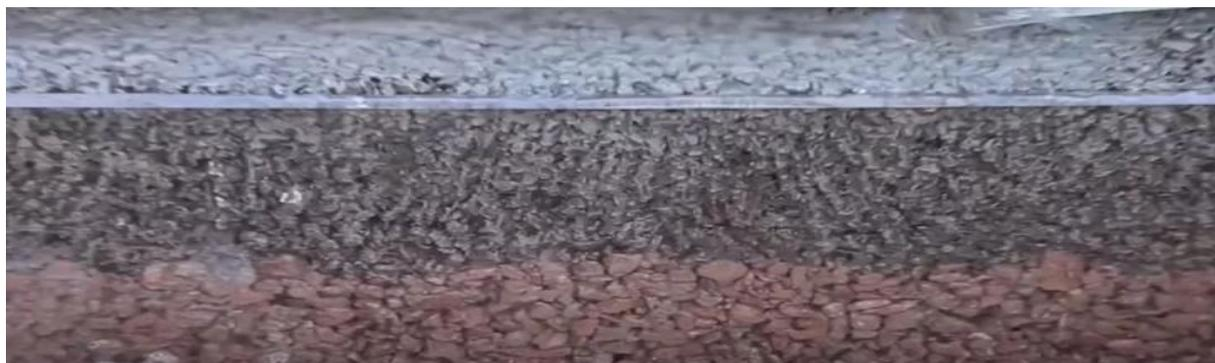
Mais autant que sa faculté à drainer l'eau et à éviter les inondations, l'intérêt du Topmix est aussi de pouvoir réduire la température des routes. En période de fortes chaleurs, l'eau stockée sous la surface permet ainsi de refroidir l'asphalte.
