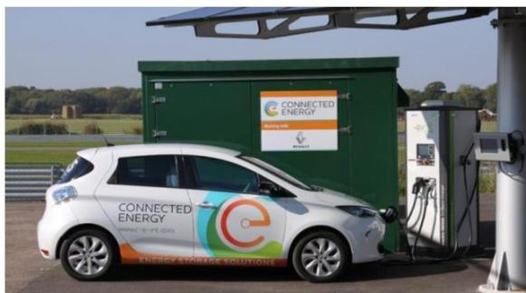
Plus original, Renault a développé avec la société britannique Connected Energy des bornes de recharge de véhicules électriques utilisant, là encore, d'anciennes batteries de ZOE ou de Kangoo Z.E. Cette technologie, baptisée E-STOR, présente de plus l'avantage de pouvoir stocker de l'énergie à partir d'une alimentation à faible puissance et la restituer à haute puissance, indispensable à la charge d'un véhicule.
